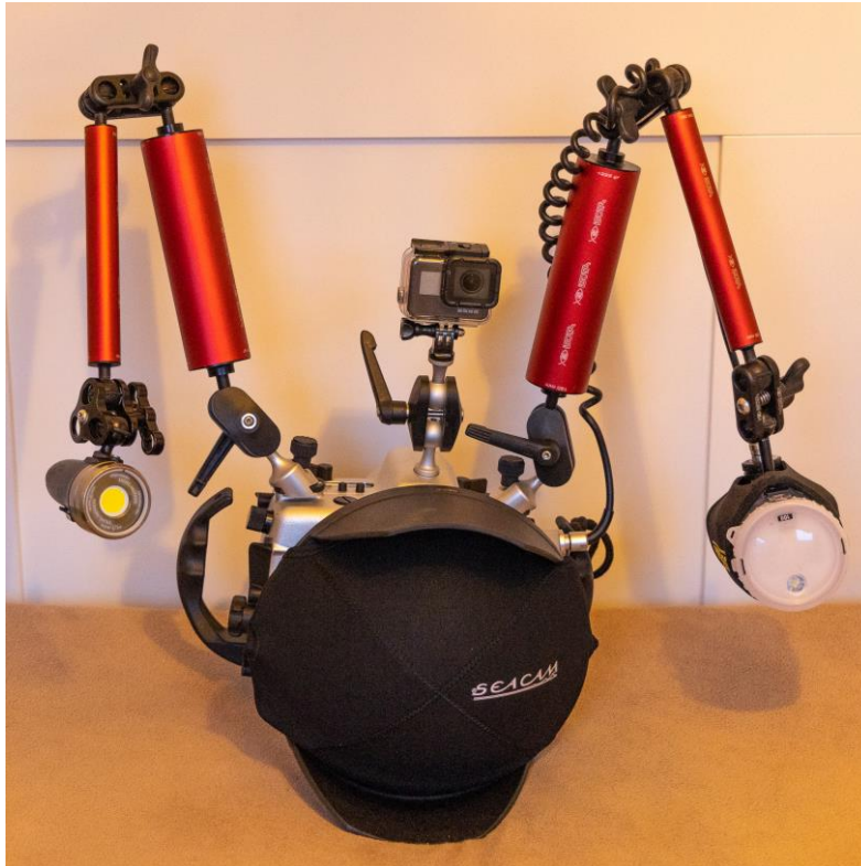
Abb. 5: Kamera-Setup der Spiegelreflex-Kamera mit mittig montierter GoPro 7, einem Blitz für die Rahmenfotos (rechts, Sea&Sea YS-D2) und einer Videoleuchte (Sola 3800) für die Megafauna-Transecte. Foto: submaris
